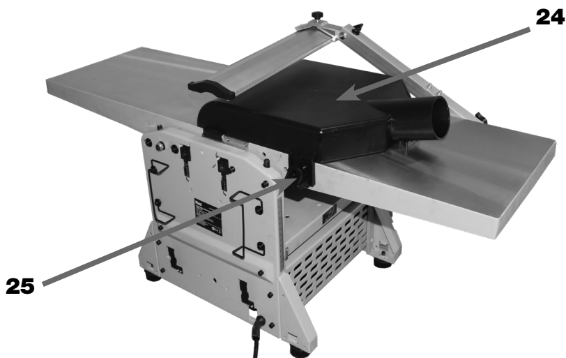
FIGURA 29 – Direcionador de Cavacos sobre a Mesa
