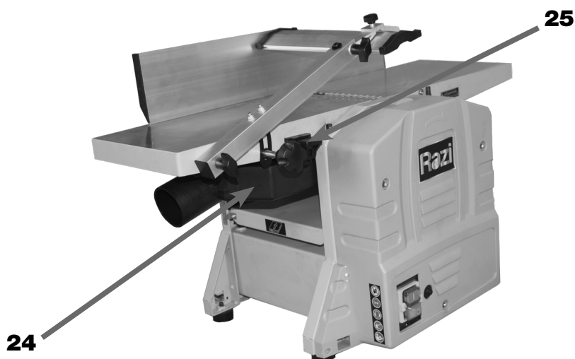
FIGURA 25 – Direcionador de Cavacos sob a Mesa
