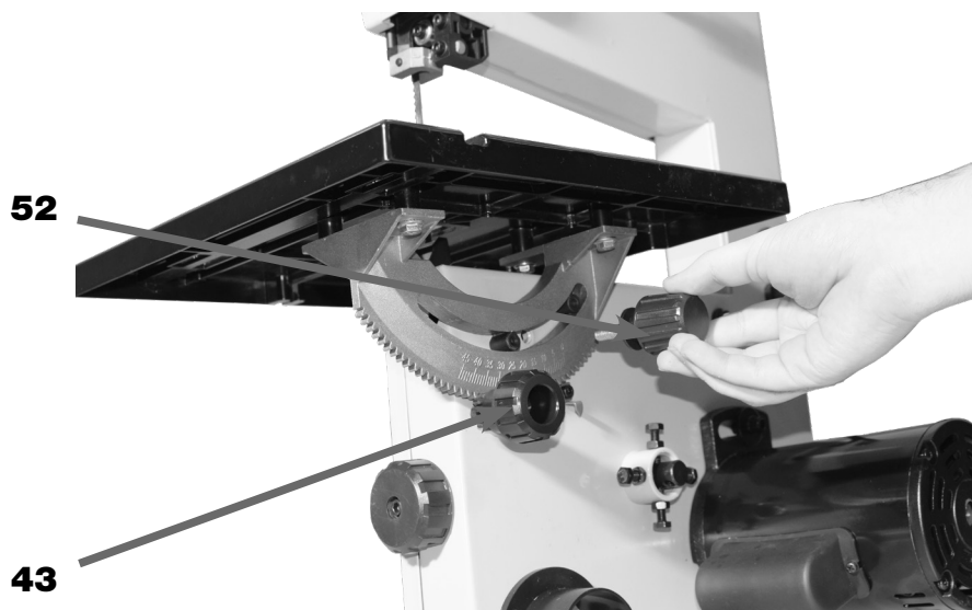
FIGURA 18 – Fixação da Mesa de Corte
