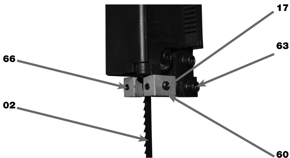
FIGURA 31 – Ajuste da Guia Superior
