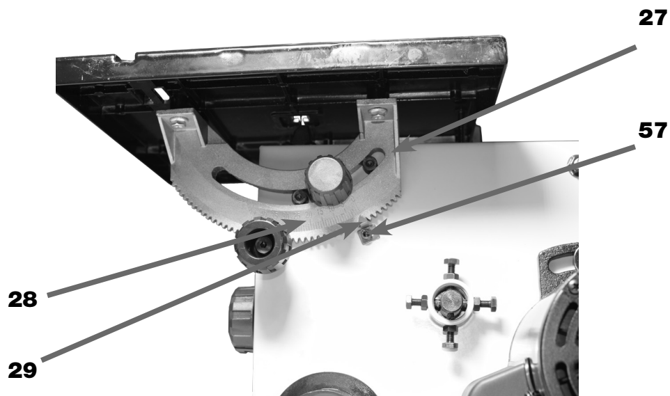
FIGURA 22 – Perpendicularidade da Mesa de Corte
