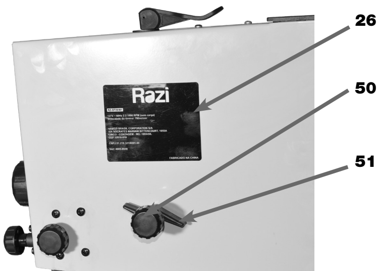
FIGURA 08 – Manípulo de Ajuste da Cambagem do Volante Movido
