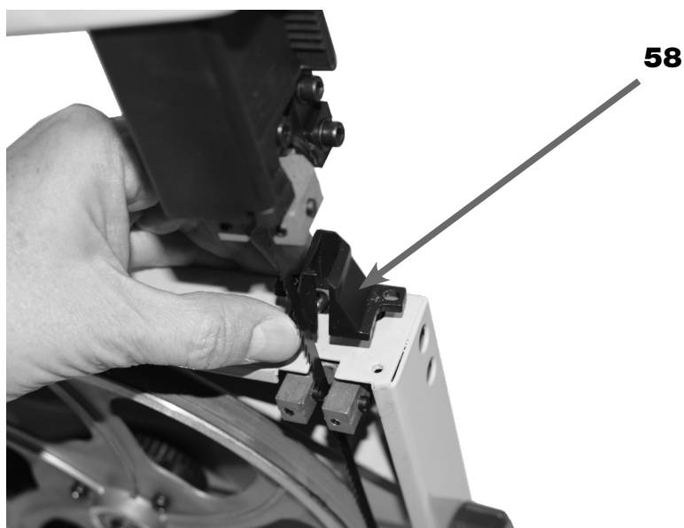
FIGURA 24 – Proteção da Guia Fixa
