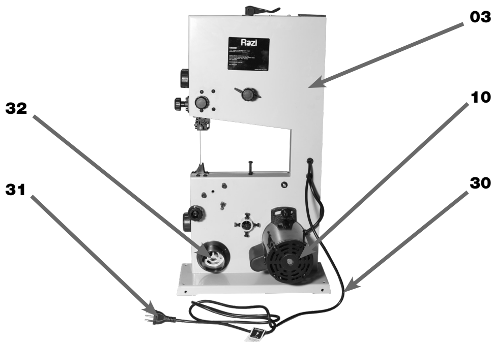
FIGURA 03B – Motor Elétrico [SEM a Mesa de Corte para melhor visualização]
