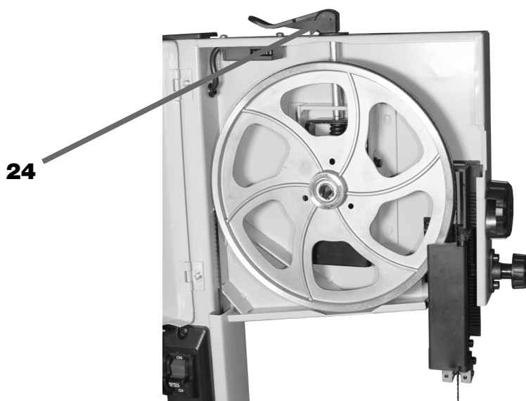
FIGURA 09B – Lâmina de Serra de Fita com tensão
