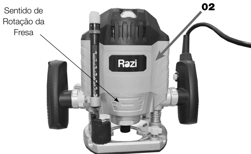
FIGURA 13 – Sentido de Rotação da Fresa
