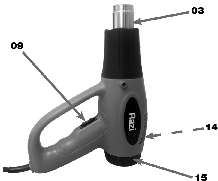
FIGURA 10 – Soprador Térmico na vertical para resfriamento
