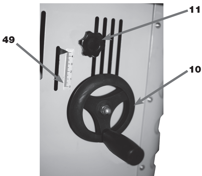
FIGURA 46 - Escala de Ajuste da Altura da Fresa
