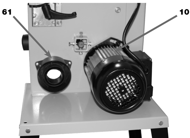
FIGURA 03B – Motor Elétrico
