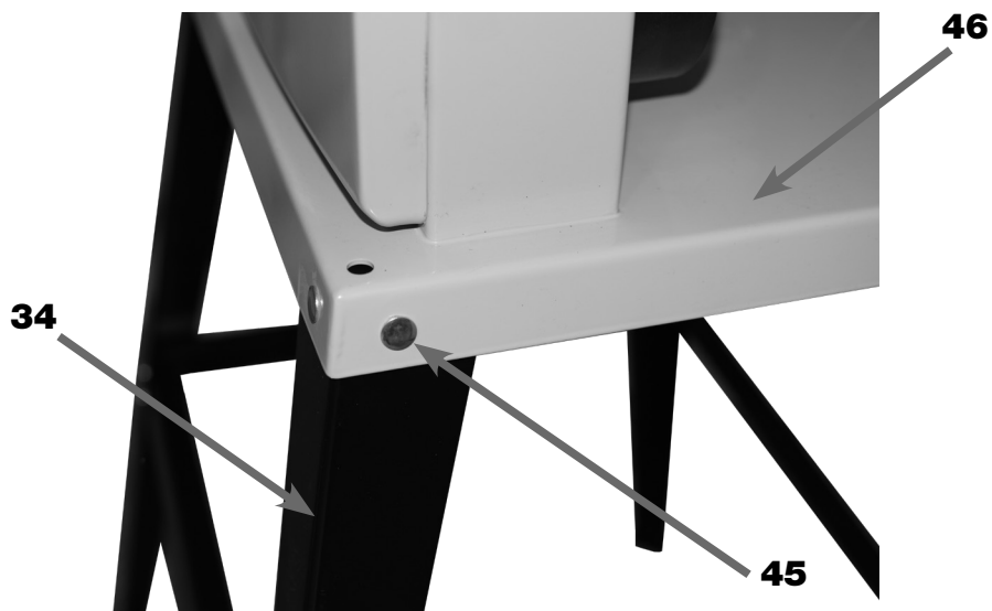
FIGURA 18 – Fixação da Base da Estrutura com o Conjunto da Base de Apoio
