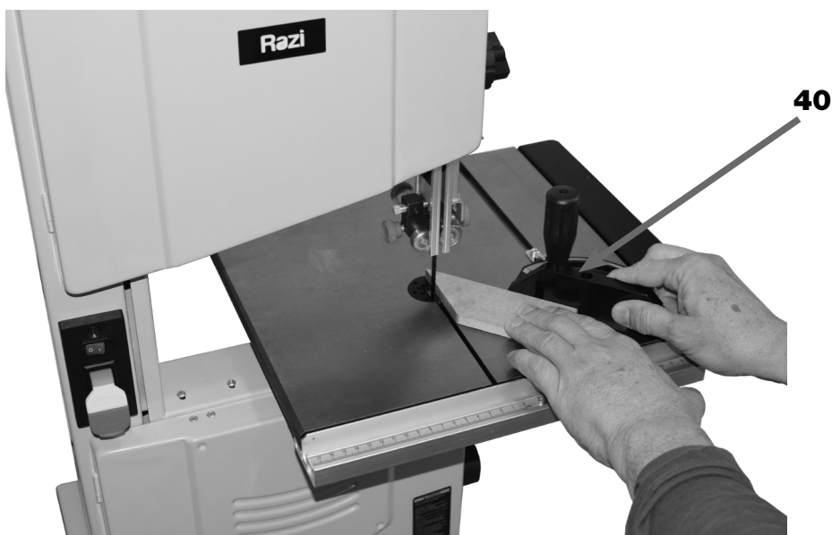
FIGURA 07 – Conjunto da Guia de Corte Angular
