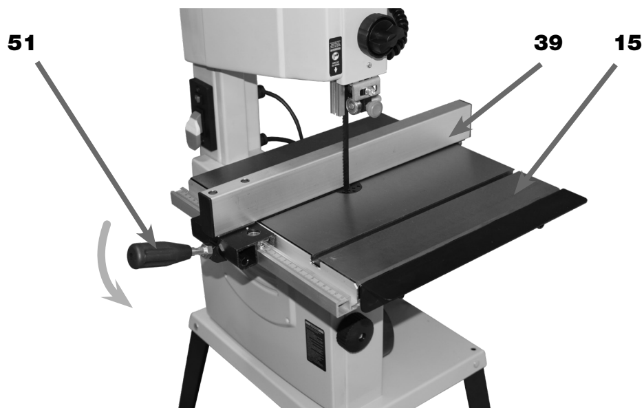
FIGURA 24 – Posicionamento da Guia Linear sobre a Mesa de Corte
