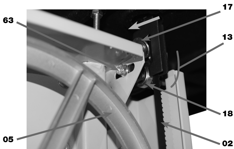
FIGURA 30 – Parafuso de Fixação da Guia Fixa
