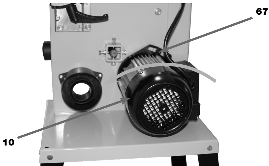
FIGURA 35A – Fixação do Motor
