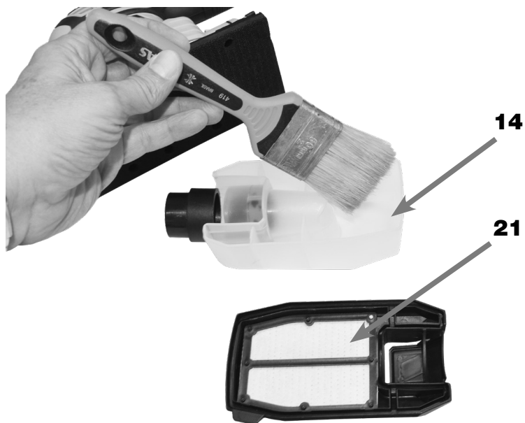
FIGURA 23 - Limpeza da Caixa Coletora de Pó com Pincel Seco
