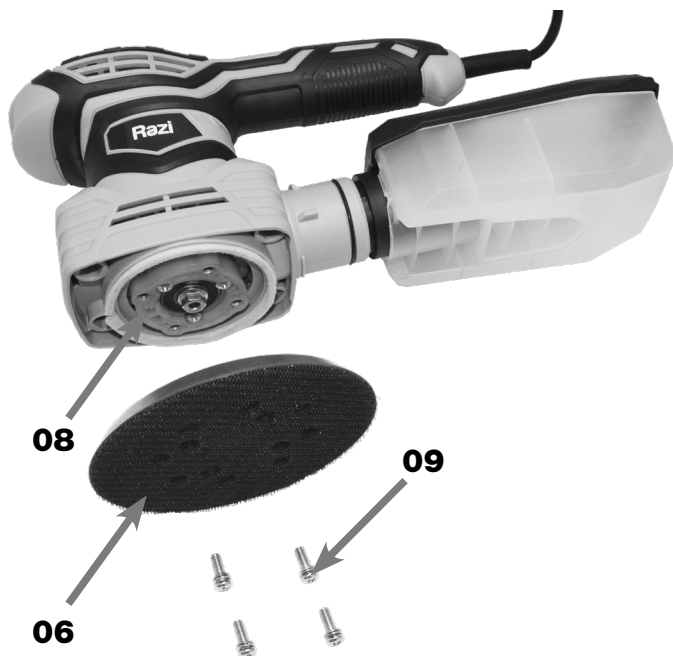
FIGURA 07 - Montagem da Placa Base Circular à Carcaça
