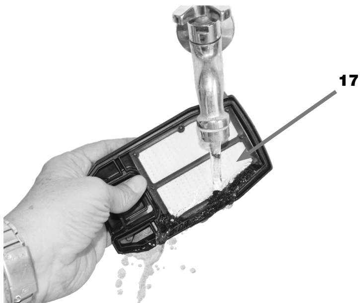
FIGURA 17 - Lavagem com água corrente no Interior da Caixa Coletora de Pó
