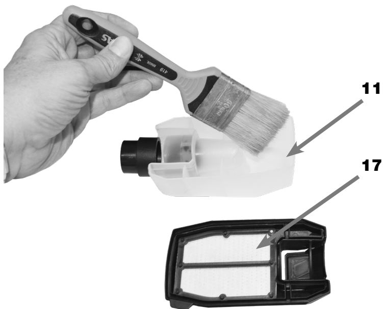
FIGURA 16 - Limpeza com Pincel Seco na Caixa Coletora de Pó
