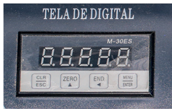
Mostrador digital informando o angulo da Serra a qual esta sendo utilizado
