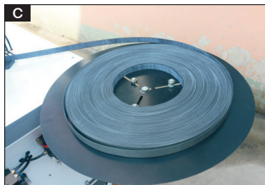
Bandeja montada com disco de abastecimento da fita de borda.
